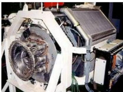
圖 6-4 4 氣缸  $\alpha$  型史特林引擎(4-95 Mark II)之示意圖，以及實物攝影(鎳基超合金細管製成的熱區(receiver)清晰可見)
